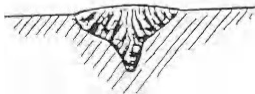
Aspecto de cordón de soldadura usando Argón
