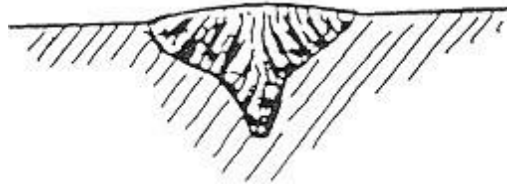
Aspecto de cordón de soldadura usando Argón
